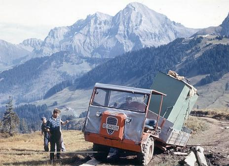
Der Öltank hingegen war zu gross für die Transportbahn. Der Muli und die Fahrer wurden für diesen Transport bis an die Grenze belastet. Mit Hilfe von Winde und Holzbalken schafften sie es schlussendlich doch, eine fahrbare Passage auf den
